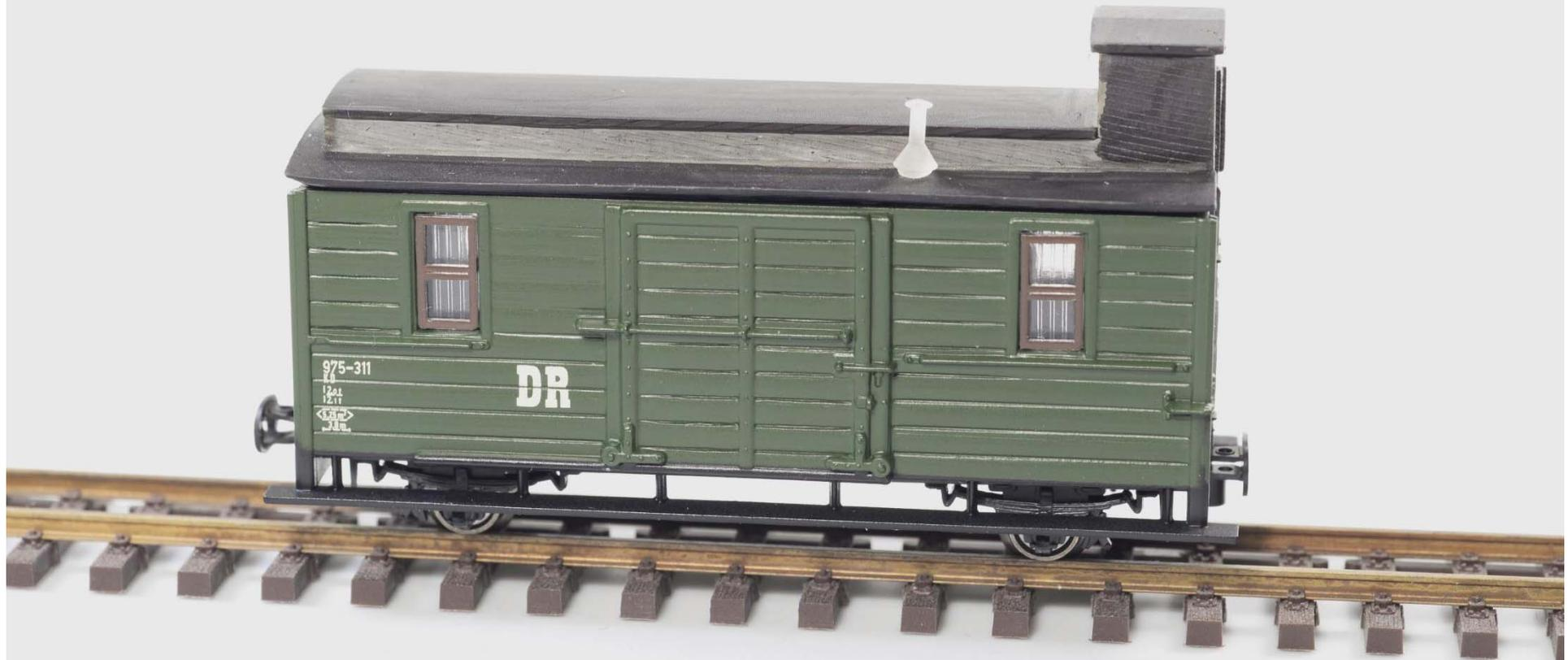
Dach in 3D-Druck, Fahrwerk & Wagenkasten (Kunststoff-Spritzguß)
