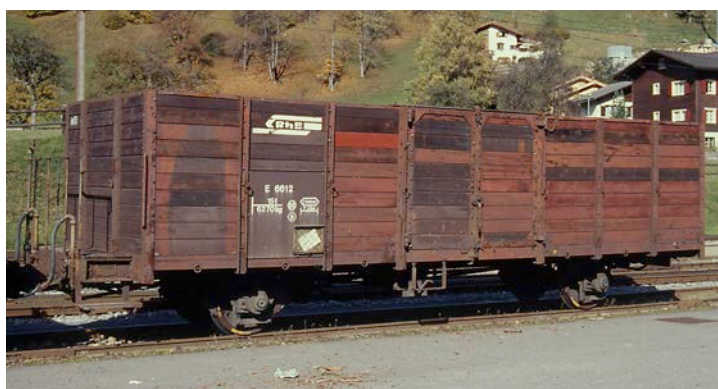
9451 112 E 6612 Hochbordwagen mit Blechtafel Bretter ausgebessert 9451 115 E 6635 Hochbordwagen mit Blechtafel
