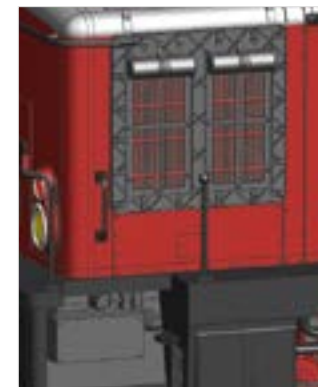
Dachlüfter- bzw. Kühlerabdeckung im offenen und geschlossenen Zustand montierbar
