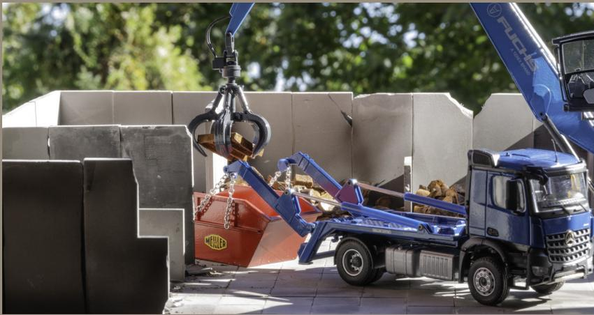
Mit dem Mehrschalengreifer lassen sich auch unförmige Teile gut aufnehmen.
