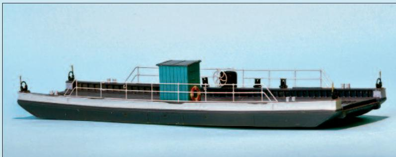
Das Deckshaus, die beiden Relings und die Führungen der Hubstangen sowie rückseitig die Winden sind auf der Fähre angebracht.
