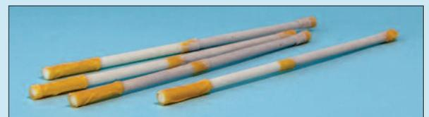
**Die Hubstangen der Auffharrampen sind mit Maskierband für den Farbauftrag mittels Airbrush vorbereitet.**
