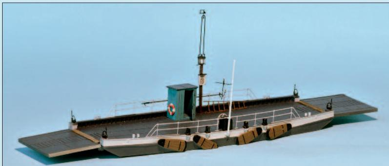
Das weitgehend fertiggestellte Modell mit der gegen die Strömung gerichteten Fähreseite. Gut zu erkennen sind die seitlichen Schwerter und die Winden, mit denen die Fahrtrichtung geändert wird.
