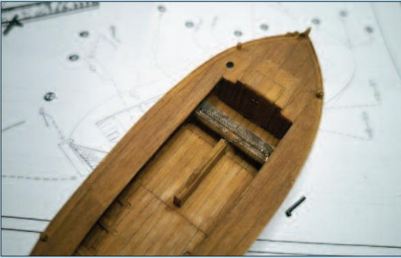
Die vordere Sitzbank mit dem angeformten Masthalter wurde eingesetzt und mit Sekundenkleber fixiert.
