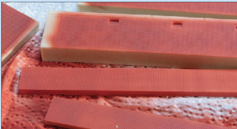
Das Bild zeigt die feine Struktur der Ziegelnachbildung der Resinteile für die Schleusenwände, die nach der Spritzlackierung gut zu erkennen ist.
