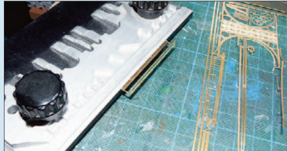
Mit Hilfe der Biegevorrichtung ist das präzise Biegen der Ätzteile für den Hauptträger kein Problem.
