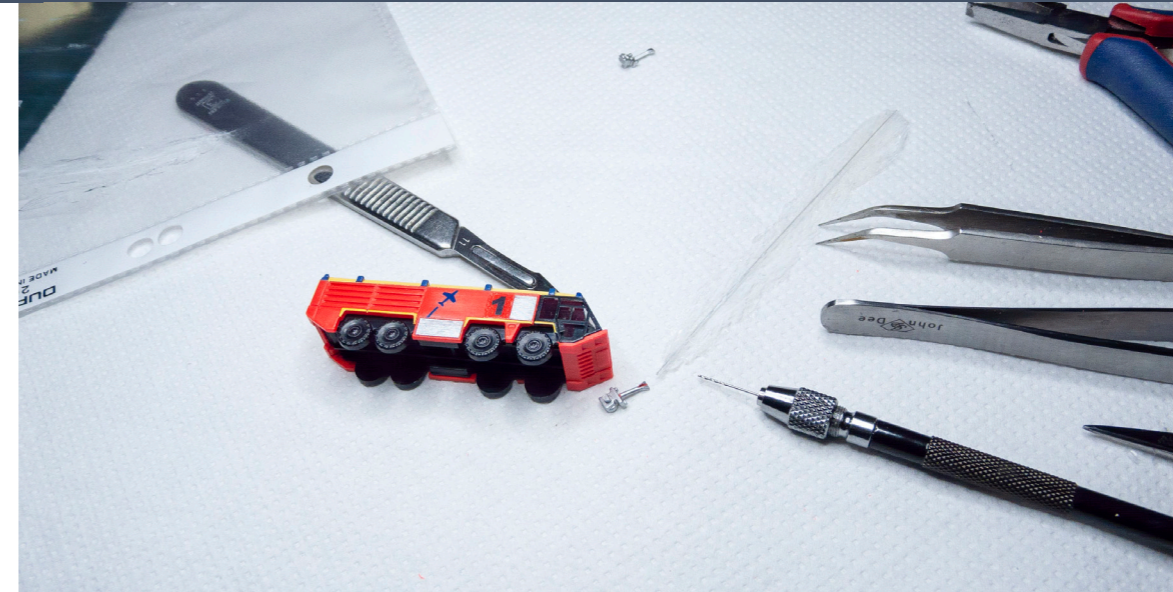
Mit einem 0,3 mm-Bohrer wurde in die beiden Löschmonitore der Flughafenlöschfahrzeuge ein Loch gebohrt, in die die Wasserfontäne befestigt wird. Mit grauweißer Acrylfarbe wird der Wasserstrahl anschließend so graniert, dass die Wirkung von Gischt entsteht. A 0.3-mm drill bit was used to drill a hole in the two firefighting monitors of the airport fire trucks, into which the water fountain is attached. Gray-white acrylic paint is then used to granulate the water jet to create the effect of spray.
